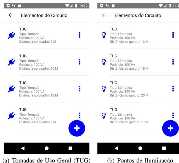
Figura 25. Telas com os elementos elétricos de um circuito
