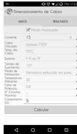
Figura 10. Dimensionamento de condutores do RCM
