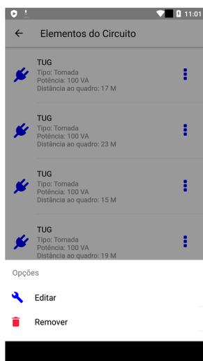
Figura 26. Pontos de carga de um circuito elétrico
