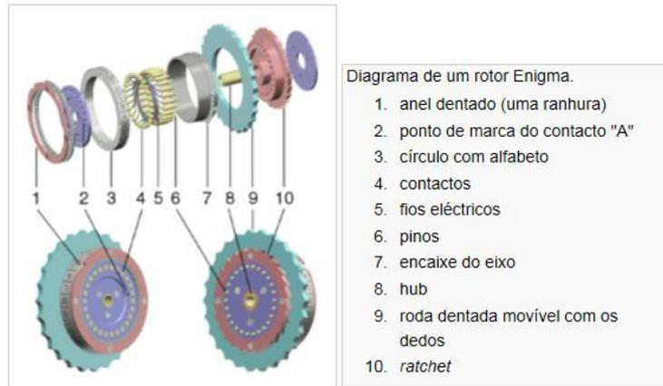
Figura 4.2: Diagrama de um rotor (WIKIPEDIA, 2012).
