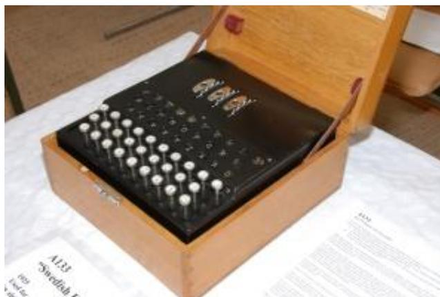
Figura 5.6: Modelo C da máquina Enigma (CRYPTO, 2012).
