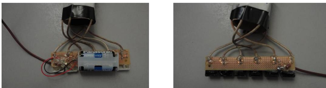
Figura 6.21: Verso do teclado de entrada e verso do teclado de saída com LEDs.
