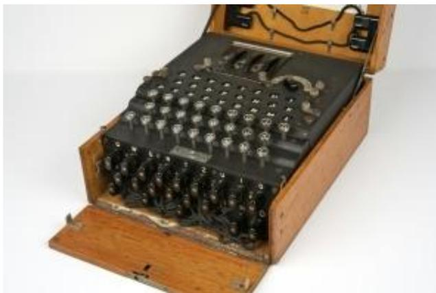
Figura 5.8: Modelo I da máquina Enigma (CRYPTO, 2012).
