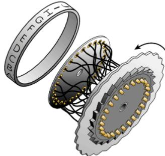
Figura 4.3: Vista esquemática de um rotor (CRYPTO, 2012).
