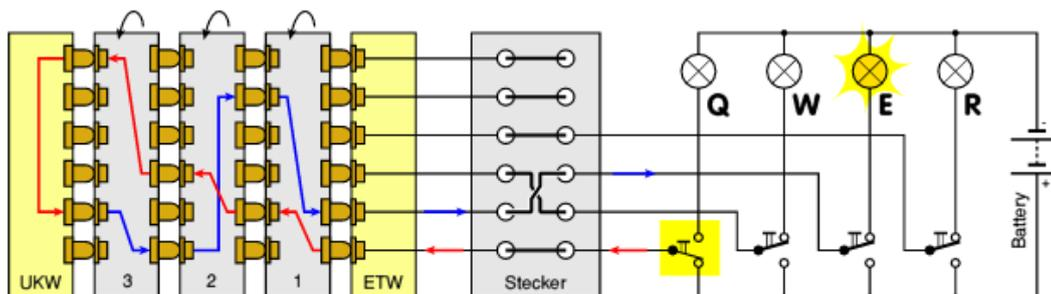
Figura 4.6: Diagrama simplificado do circuito de uma Enigma I (CRYPTO, 2012).
