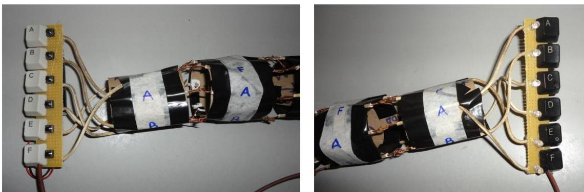
Figura 6.20: Teclado de entrada e teclado de saída com LEDs do protótipo.
