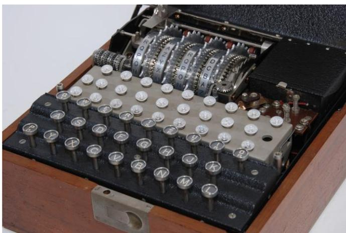
Figura 5.11: Modelo G da máquina Enigma (CRYPTO, 2012).
