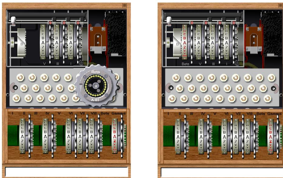
Figura 6.14: Anel beta na configuração A-01 e configuração interna completa.
