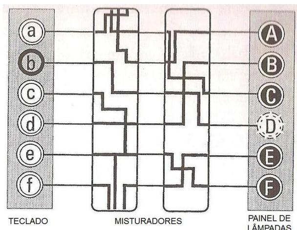
Figura 6.18: Diagrama de funcionamento da máquina Enigma (SINGH, 2011).
