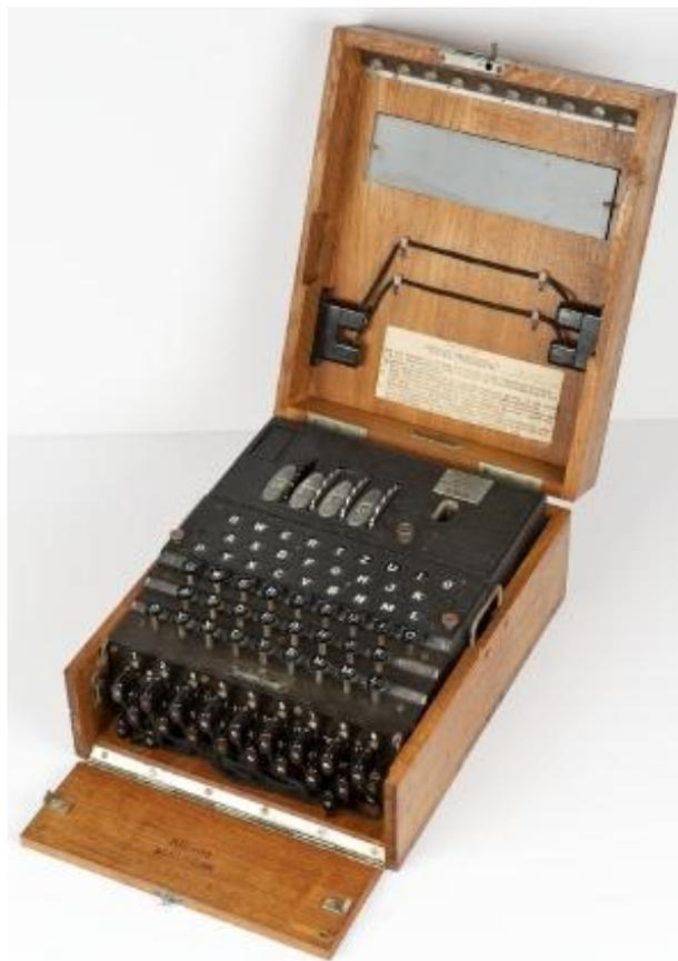
Figura 5.14: Modelo M4 da máquina Enigma (CRYPTO, 2012).
