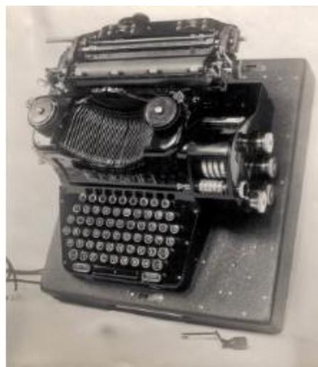
Figura 5.5: Modelo B da máquina Enigma (CRYPTO, 2012).
