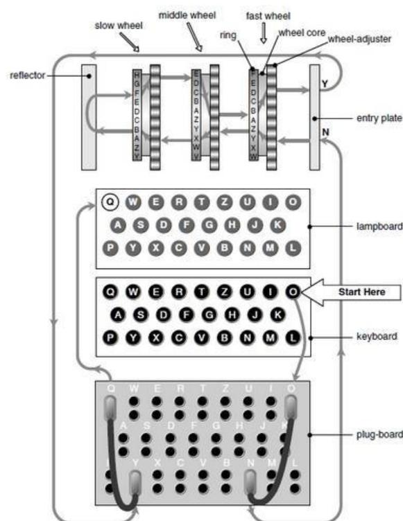
Figura 4.1: Estrutura e componentes de uma máquina Enigma (CRYPTOOL, 2012).
