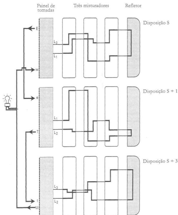
Figura 8.7: Circuito completo com 3 máquinas Enigma (SINGH, 2011, p. 196).
