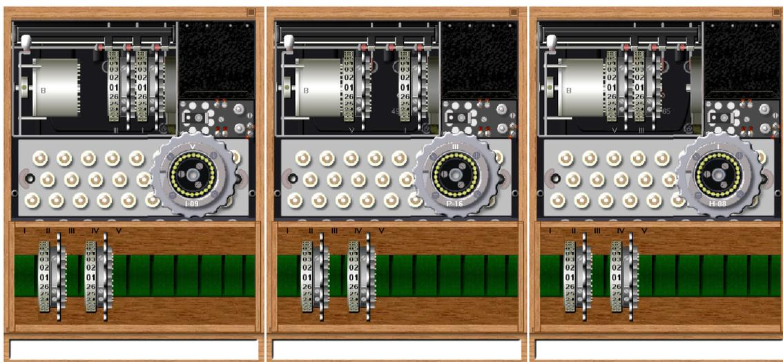
Figura 6.9: Configuração dos anéis.
