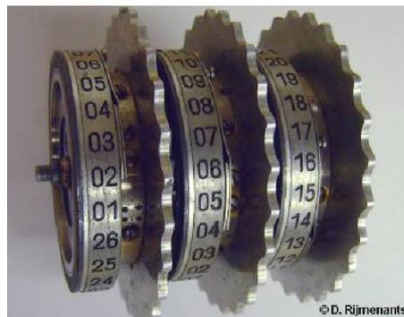
Figura 4.4: Rotores enfileirados no eixo (RIJMENANTS, 2012).
