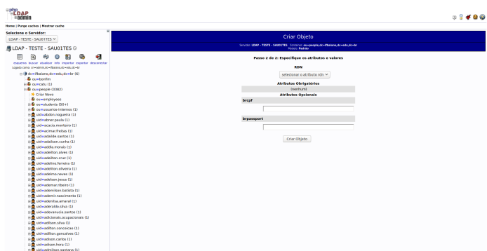
Figura 4. PhpLDAPAdmin - Tela criação do usuário no serviço de diretórios utilizando atributos da classe BrPerson. Fonte: capturada da instância do IFBaiano
